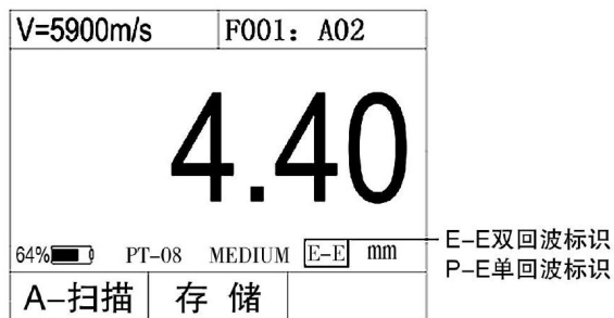
图 3.9 穿透涂层模式厚度测量界面
